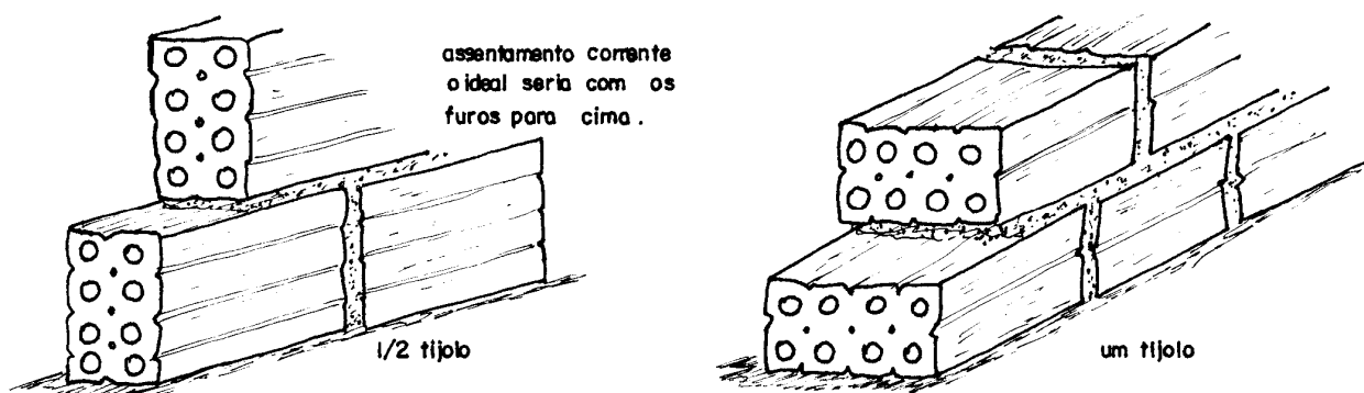
Figura 4.25 - Execução de alvenaria utilizando tijolos furados
