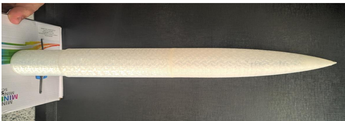
Figura 12 - Nosecone impresso em poliamida
