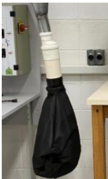
Figura 16 – coletor do overflow
