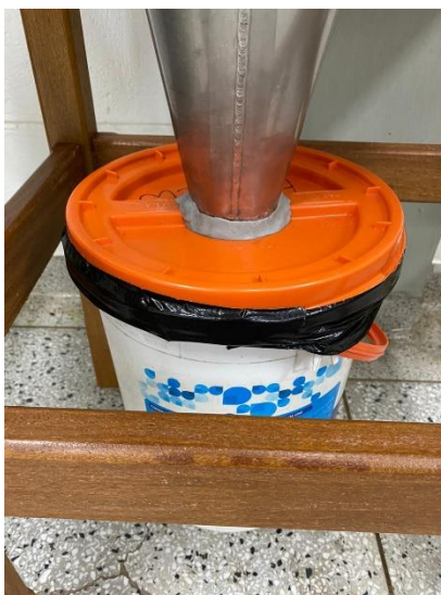
Figura 15 – coletor do underflow .
